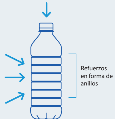
Reparto de material y fuerzas laterales durante el almacenamiento
